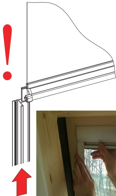
Querleiste vorichtig bis zu Anschlag in die Führungseisen einstecken und seitlich mit passenden Schrauben fixieren.
