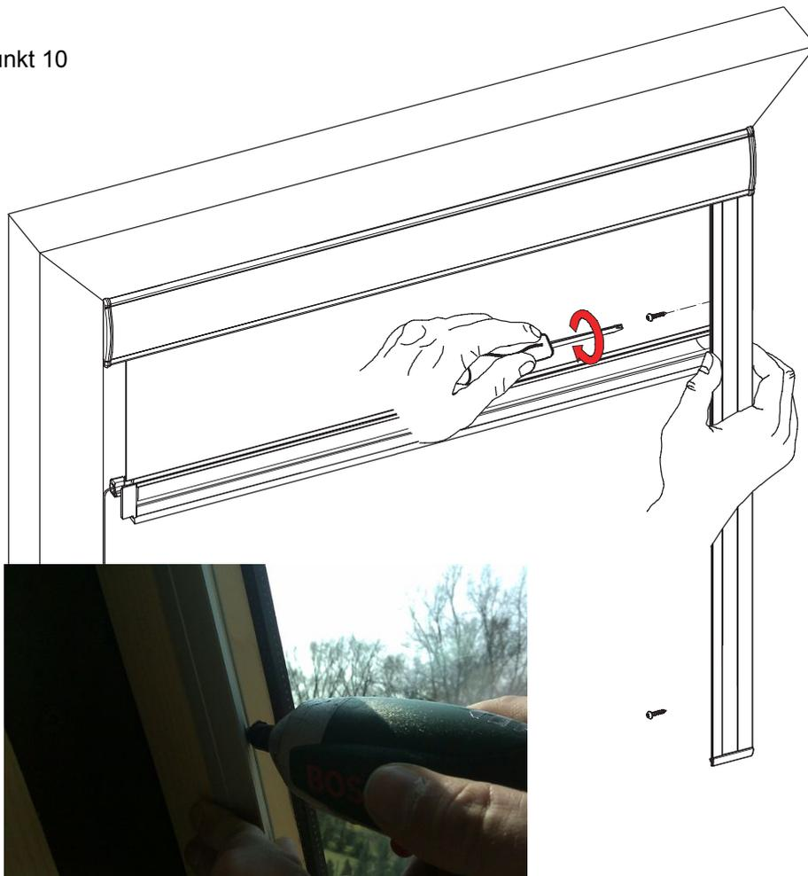
Spannseile entsprechend der Führungsschienenlänge, Blenden markieren und auf beiden Seiten auf gleicher Höhe Knoten machen, evtl. vor dem Führungsschienen anschrauben entsprechende Punkte markieren und Knoten vorbereiten sowie Knoten einstecken und erst dann Führungsschienen fest schrauben.
