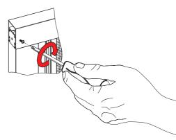
IS-Elemente mit Schrauben oder Nieten vor dem Öffnen sichern
