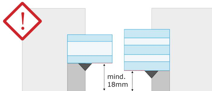
Bei der **Montage auf der Glasscheibe** muss beachtet werden, dass die Fensterfalz - Breite je nach Verglasung variiert. Empfohlen wird eine Fensterfalz-Höhe von mindestens 25mm, ist jedoch bis 18mm möglich.
