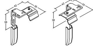
Glasleistenwinkel F, Paar
