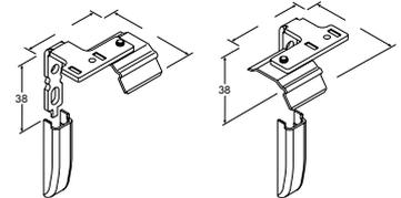
Glasleistenwinkel F, Paar
