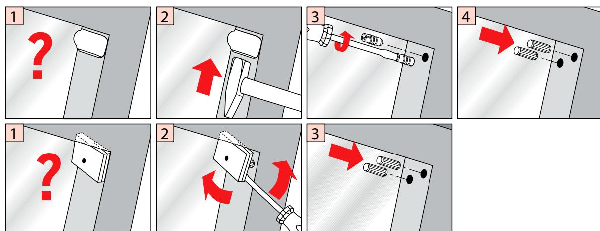
Montage der Anlage bündig mit der Fenstervorderkante.
