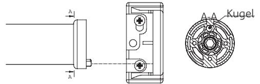
Bei der Montage des Federmechanismusstiftes unten gibt es die Möglichkeit nach jeder Umdrehung des Rollos zu stoppen.
