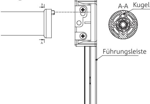
Bei der Montage des Federmechanismusstiftes oben gibt es keine Möglichkeit nach jeder Umdrehung des Rollos zu stoppen. Das Stoffrollo muß mit Führungsschienen ausgestattet werden - es kann nur mittels der Kerben in den Führungsschienen stoppen.
